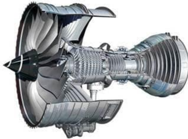
Trent 1000 – 787 20 fan blades; 112 inch fan 74K Thrust
